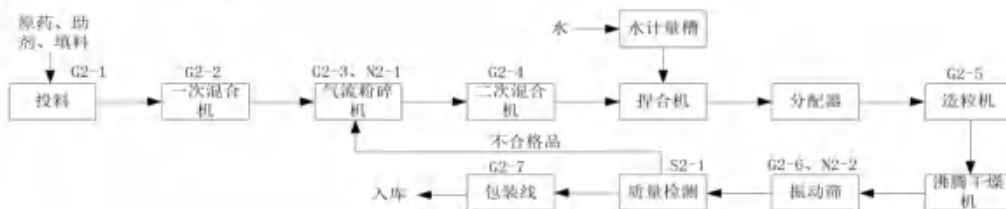
图 3 颗粒剂生产线工艺流程及排污节点图
