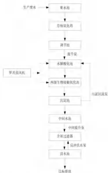
图 10 污水处理生产工艺流程及排污节点图
