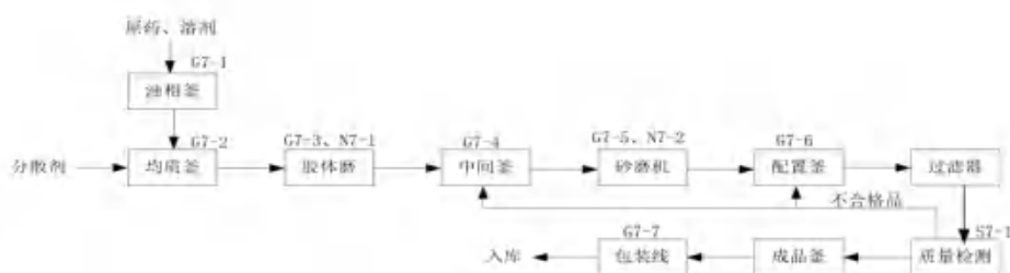
图 8 悬浮剂生产工艺流程及排污节点图
