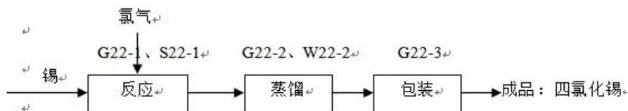
图 3-22 四氯化锡生产工艺流程及排污节点图
