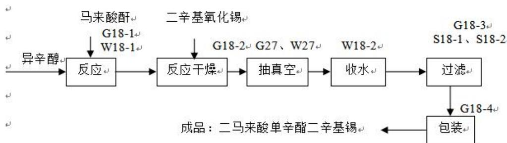
图 3-18 二马来酸单辛酯二辛基锡生产工艺流程及排污节点图
