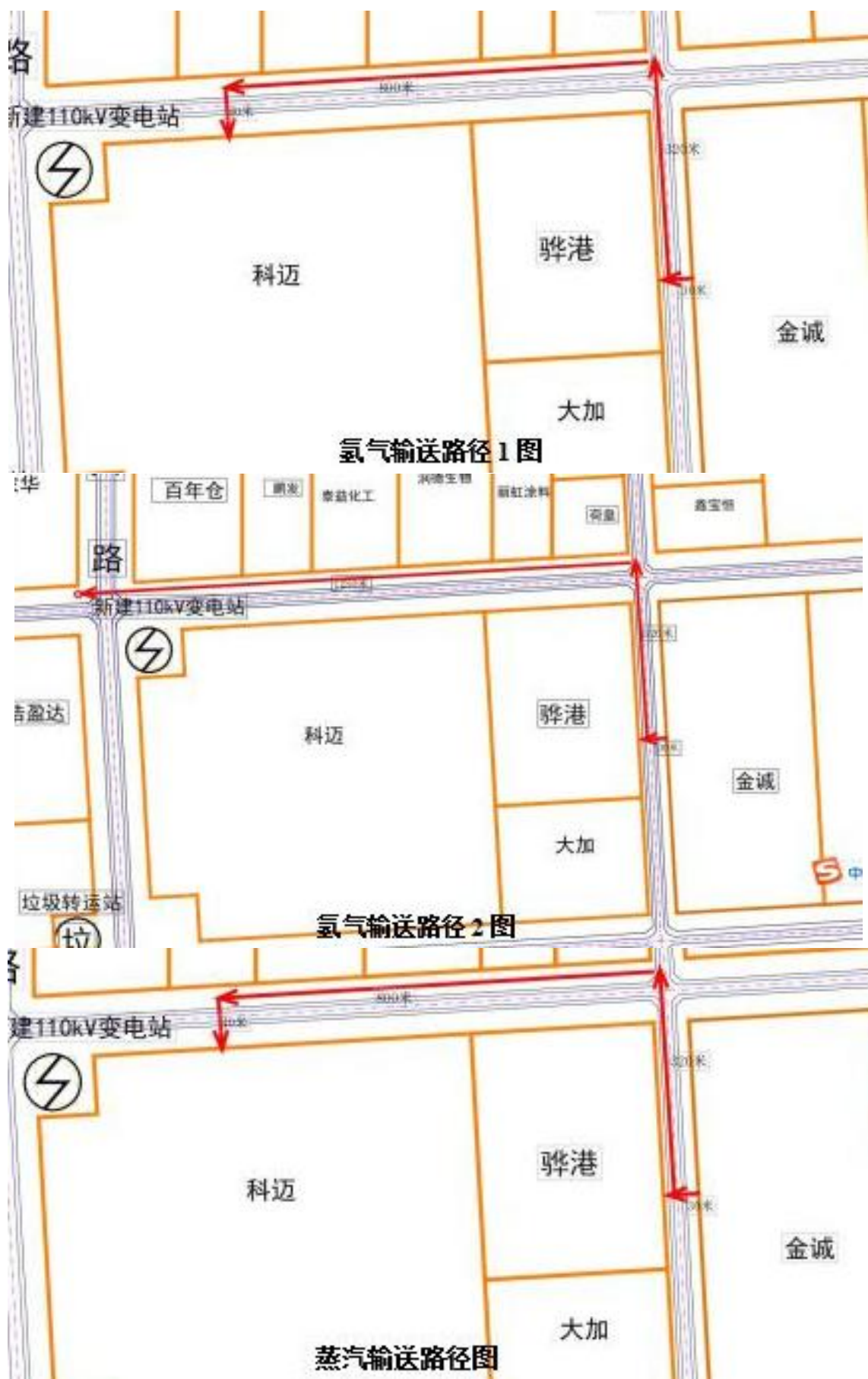
附图 2 气体管路走向图
