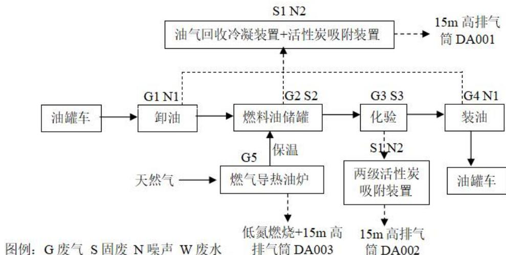
图 2 工艺流程及排污节点
